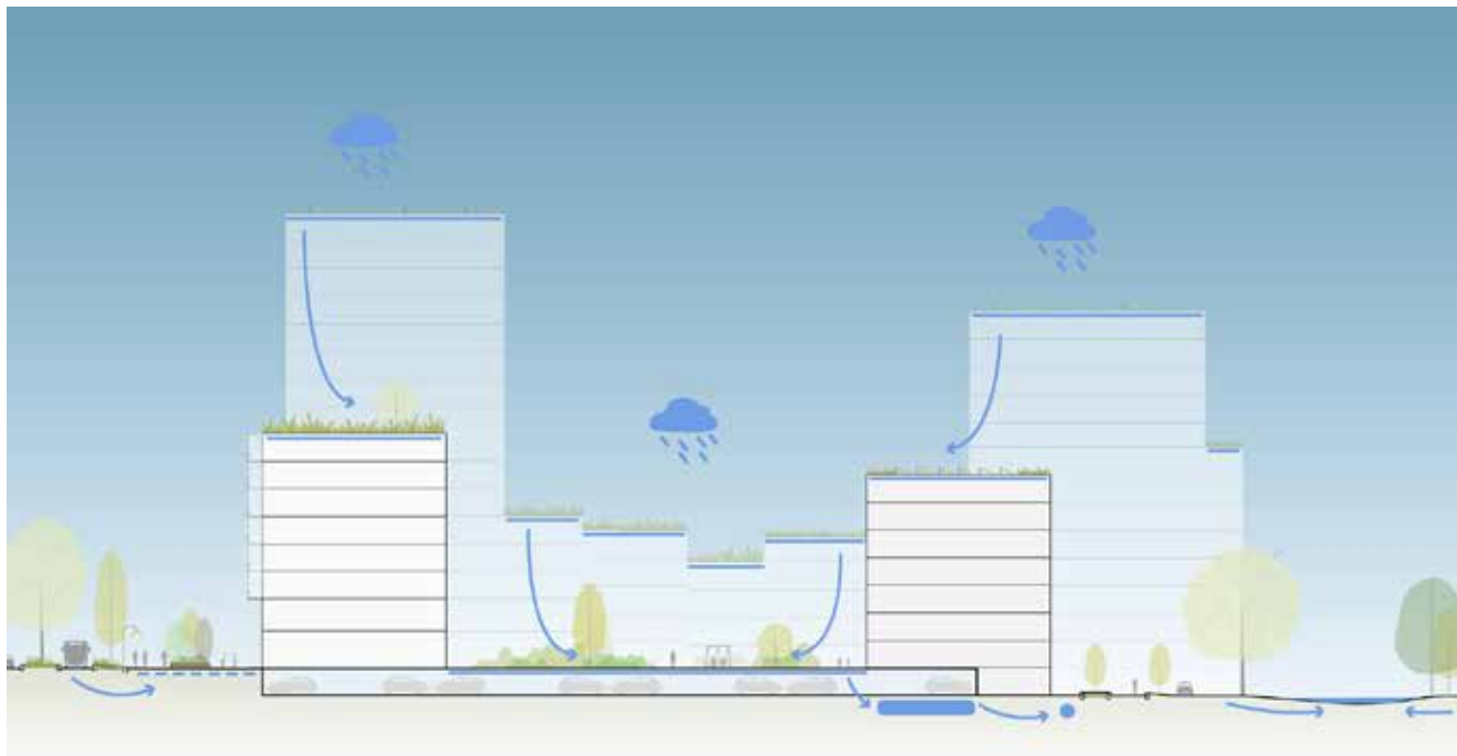
Principedoorsnede waterberging en vertraagde afvoer op en rondom het stedelijk blok ten behoeve van klimaatadaptatie
